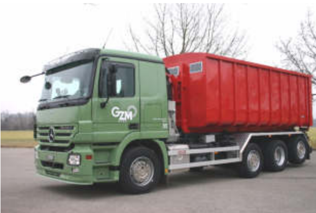
In der GZM und in der TMF steht je eine mobile Tötungseinrichtung mit CO 2 Gas für Geflügel bereit. In der Mulde sind sechs 800 l Container mit allem nötigen Zubehör enthalten
