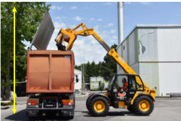
Mindeste Höhe für Einkippen in Seuchenmulde auf Fahrzeug 6.30 m
