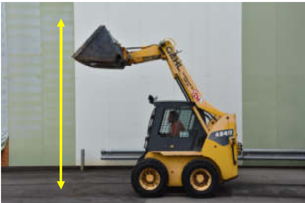
Hubhöhe mit Schaufel: 3.50 m.
