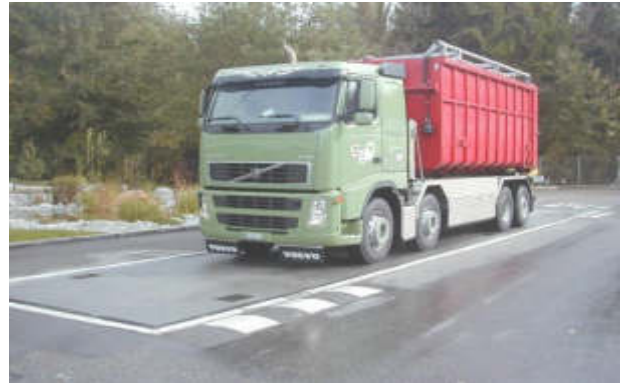
Der eintreffende Camion wird auf der elektronischen Waage eingewogen.
