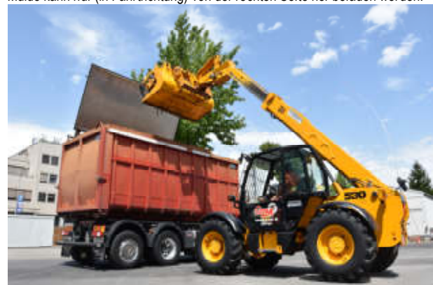
Bei wenig Platz für Absetzen der Mulde kann auch direkt geladen werden.
