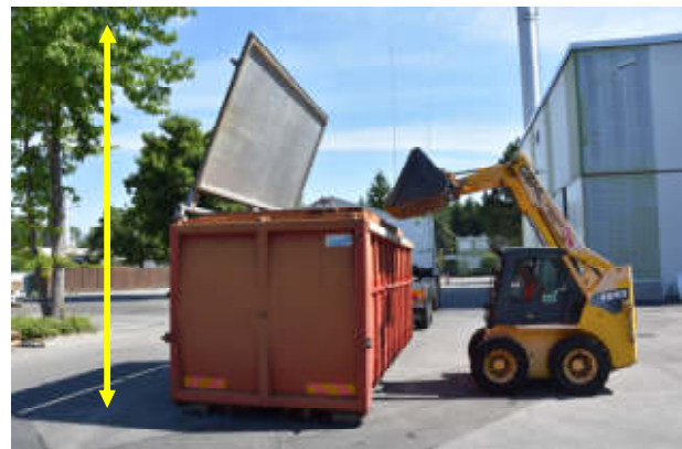
Mindeste Höhe für Einkippen in Seuchenmulde: 5.00 m Für Kleinkadaver kann Deckel evtl. weniger geöffnet werden, so dass dann mit einer Mindesthöhe von ca. 4.00 m gerechnet werden kann. Mulde kann nur (in Fahrtrichtung) von der rechten Seite her beladen werden!
