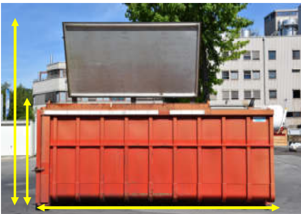
Grosser luftdichter Muldendeckel für einfaches Beladen der Kadaver. Die Mulden haben eine Abmessung von ca. L: 6.40 m / B: 2.50 m / H: 2.6 m Muldenhöhe mit geöffnetem Deckel: 4.70 m
