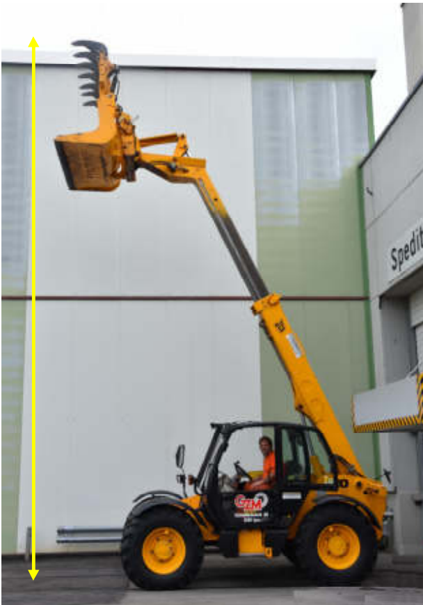
Hubhöhe mit Greifer: 8.80 m.
