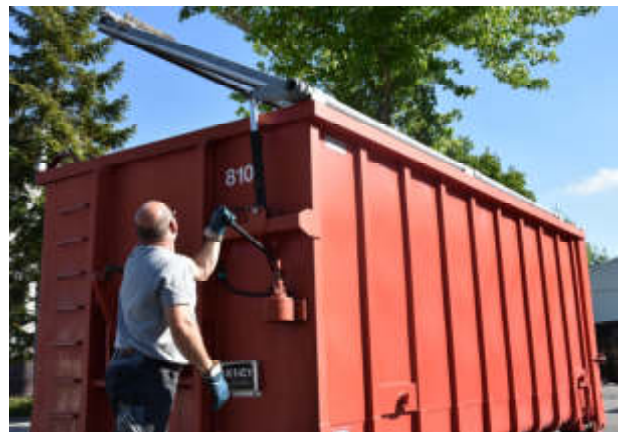
Durch Hydraulikpumpe lässt sich der Muldendeckel leicht von Hand öffnen.
