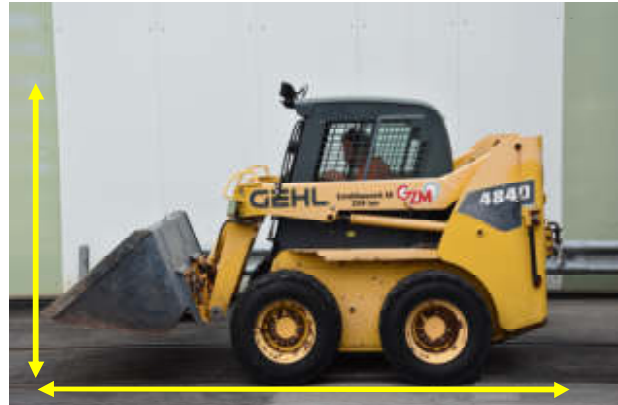
Fahrzeuglänge mit Schaufel: 4.00 m - Fahrzeughöhe: 2.20 m
