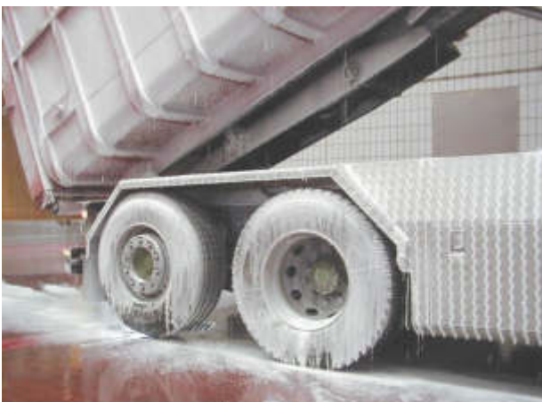
Mit speziellen Schaumlanzen wird eine gleichmässige Verteilung des Reinigungs- und Desinfektionsmittels erreicht.
