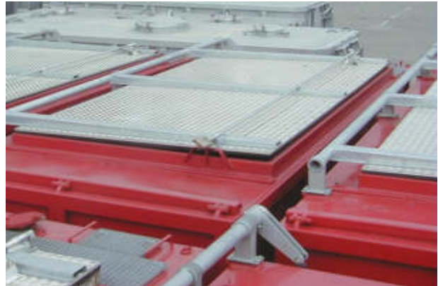
Die vorhandenen Mulden haben eine grossen dichtschiessenden Deckel und ein Ladevolumen von 28 m 3 . Das entspricht etwa 12 bis 15 Grosstierkadavern, bzw. ca. 8 bis 12 Tonnen Verladegewicht.
