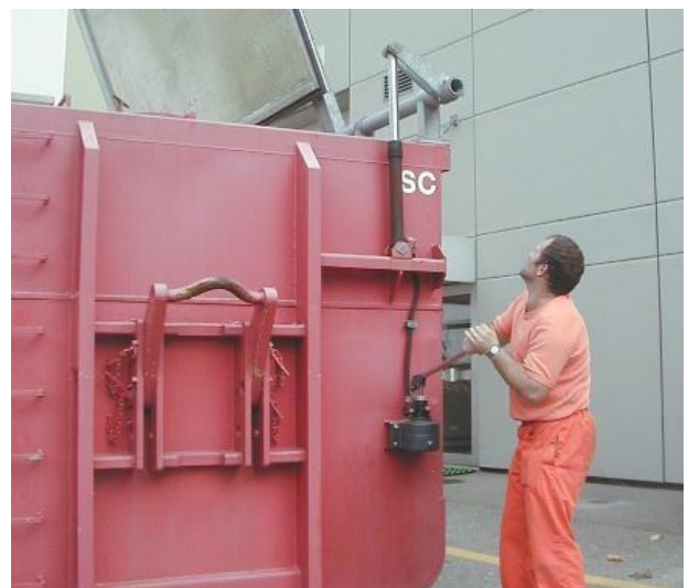
Durch Hydraulikpumpe lässt sich der Muldendeckel leicht von Hand öffnen
