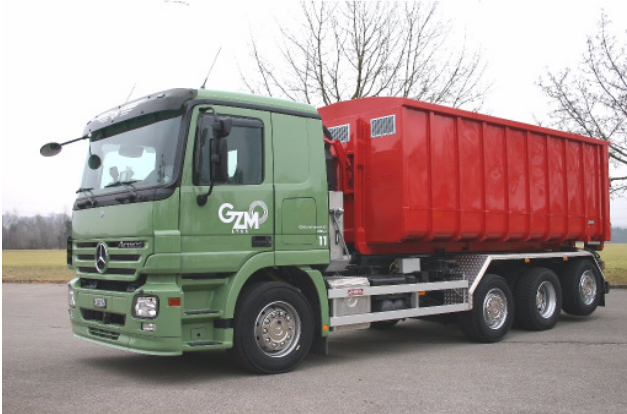
In der GZM und in der TMF steht je eine mobile Tötungseinrichtung mit CO 2 für Geflügel bereit. In der Mulde sind sechs 800 l Container mit allem nötigen Zubehör enthalten.
