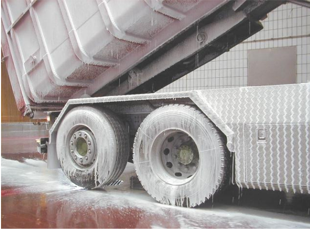
Mit speziellen Schaumlanzen wird eine gleichmässige Verteilung des Reinigungs- und Desinfektionsmittel erreicht
