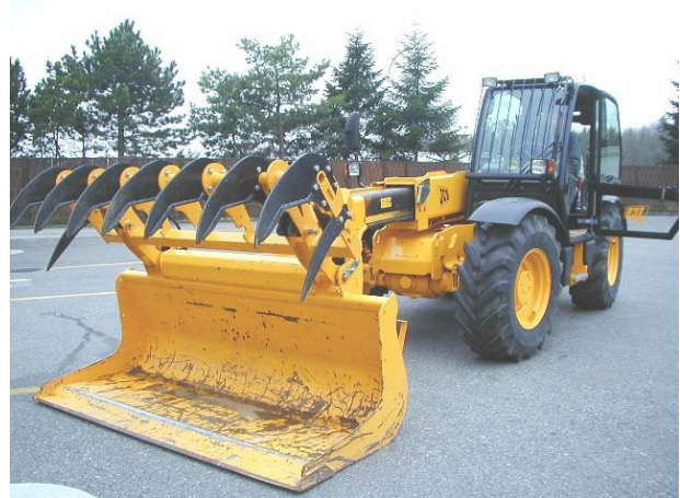
Modernes leistungsfähiges Allradladerfahrzeug mit Hubhöhe bis 7 m
