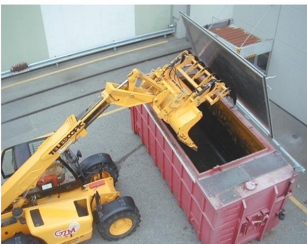
Dank der grossen Ladeöffnung und dem geeigneten Ladefahrzeug können auch grosse Kadaver problemlos und schnell geladen werden
