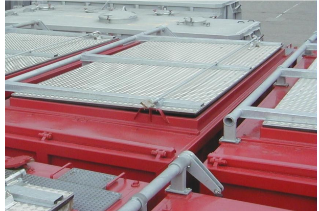
Für den Seuchenfall stehen spezielle Mulden zur Verfügung die luft- und wasser-dicht sind und sich durch grosses Ladevolumen von 28 m 3 auszeichnen.
