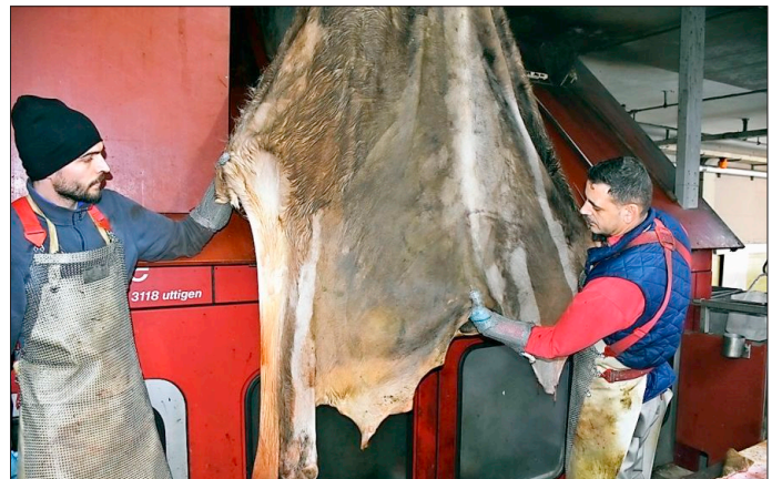
Zwei Mitarbeiter untersuchen die Haut auf Mängel und teilen sie in die Klassen 1 bis 3 ein.
