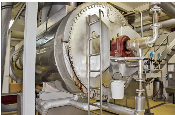
In diesem Tank werden die zerkleinerten Schlachtabfälle unter Druck bei 133 Grad sterilisiert. (Bilder: Doris Bigler)
